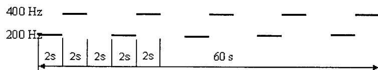
5) Zkušební tón pro akustickou zkoušku elektrických a elektronických sirén
